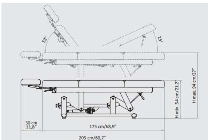
Sur le Lemi Sosul E1, la hauteur du lit est facilement réglable électriquement au moyen d'une pédale. Le réglage du dossier s'effectue manuellement à l'aide d'un vérin à gaz, le repose-pieds, le repose-jambes et la tête-rière sont réglés manuellement. La tête de massage polyvalente est incluse dans la livraison. Le piétement est de forme elliptique, fabriqué en acier et revêtu par poudre. Le rembourrage est composé d'une mousse de qualité recouverte de simili-cuir.
